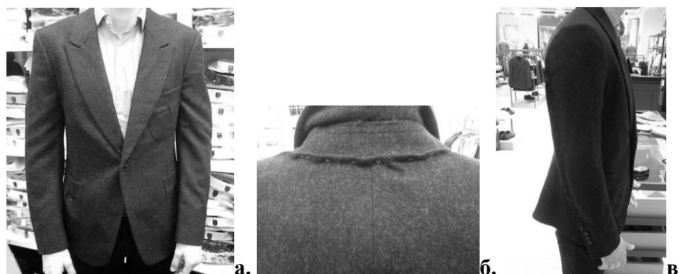
Рис. 1. Корректировка конструкции мужского костюма: а) примерка на фигуре покупателя; б) корректировка длины спинки; в) корректировка ширины рукавов
